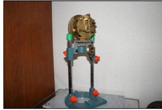
調整用スタンド取り付け
